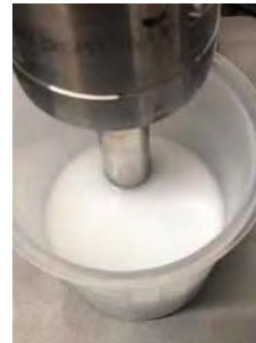
Illustrasie 1: Mengsel toon geen fase-oordrag nie en sou volgens alle standarde van die "jar test" geslaag het.
