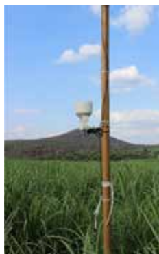
Figuur 1: Kapasitansvogmeter metingspunt met reënmeter wat ononderbroke data aanteken en met GPRS aanstuur.
