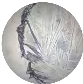
Figuur 3: Links: Groot groeilamelle met hoë konsentrasie op die rand van die druppel. Regs: Klein groeilamelle, deeglik versprei met eweredige konsentrasie oor die druppel.
