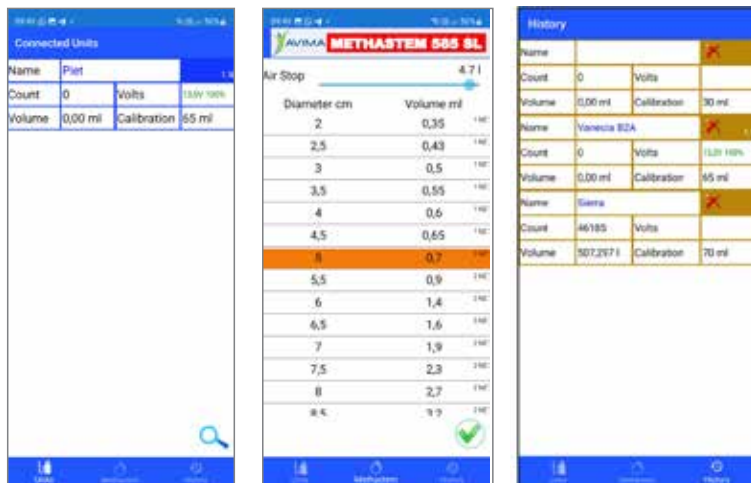
Figuur 4: Drie bladsye is op die toep beskikbaar waar die spuit(e) benoem en gekalibreer word asook waar data versamel word van die aantal bome wat behandel is en die spuitvolume wat daaglik toegedien word.
